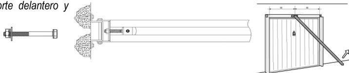
7 - Ajuste la longitud de los soportes de montaje en el techo del automóvil para lavar, respetando las dimensiones mínimas recomienda 50 mm entre el perfil soporte y la puerta. Fije los soportes para el motor y el techo;
