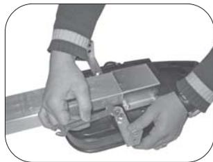
6.....Colocar el motor en el soporte frontal y apretar el tornillo de unión;
