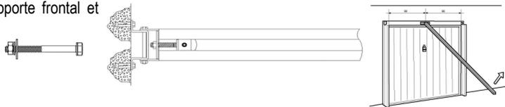
7 – Ajuster la longueur des équerres de fixation du moteur au plafond, afin qu'il reste nivelé, tout en respectant les quotas minimum conseillé, de 50mm entre la barre et la porte sectionnée;
