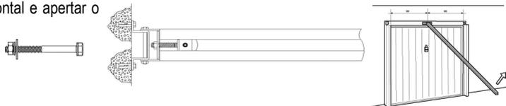
7 - Ajustar o comprimento dos esquadros de fixação do motor ao tecto, de modo a ficar nivelado, respeitando as cotas mínimas aconselháveis, de 50 mm entre a calha e a porta seccionada. Fixar os esquadros ao motor e ao tecto;
