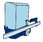
**Instalação de cremalheiras:** Fixe a cremalheira ao portão com parafusos e ajuste a posição da cremalheira para que esta possa ser encaixada corretamente com a roda dentada do motor. O espaço entre a roda dentada e a cremalheira deve ser de 1.5 mm.
