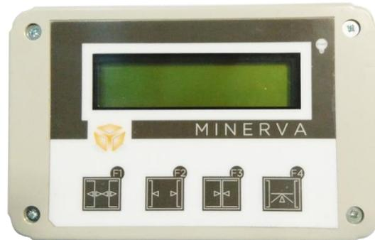
Fig. ... – Seletor digital de funções da porta automática Minerva
