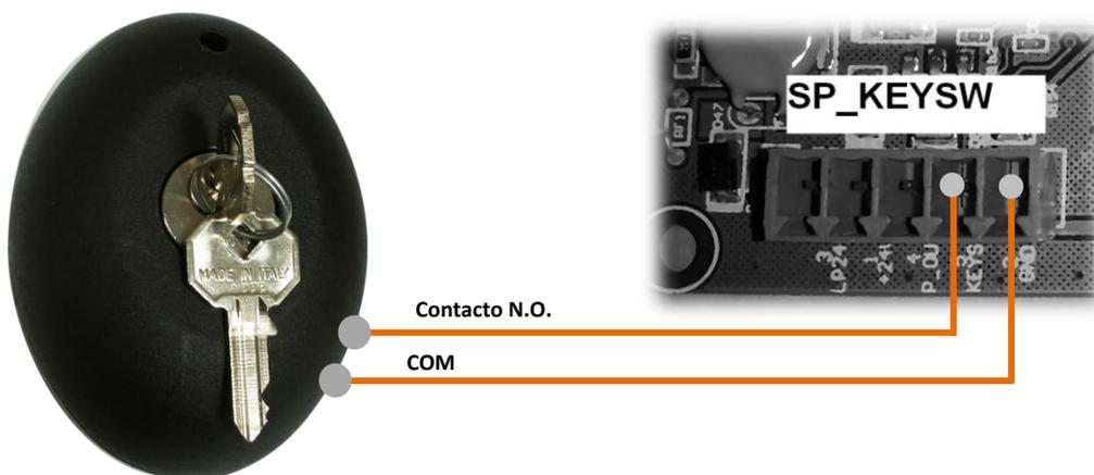
Fig. ... – Exemplo de esquema de ligação para funcionamento de um seletor de chave na entrada **SP\_KEYSW**.
